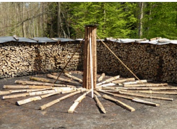
In der Mitte wird zuerst das Füllihuus gebaut...
