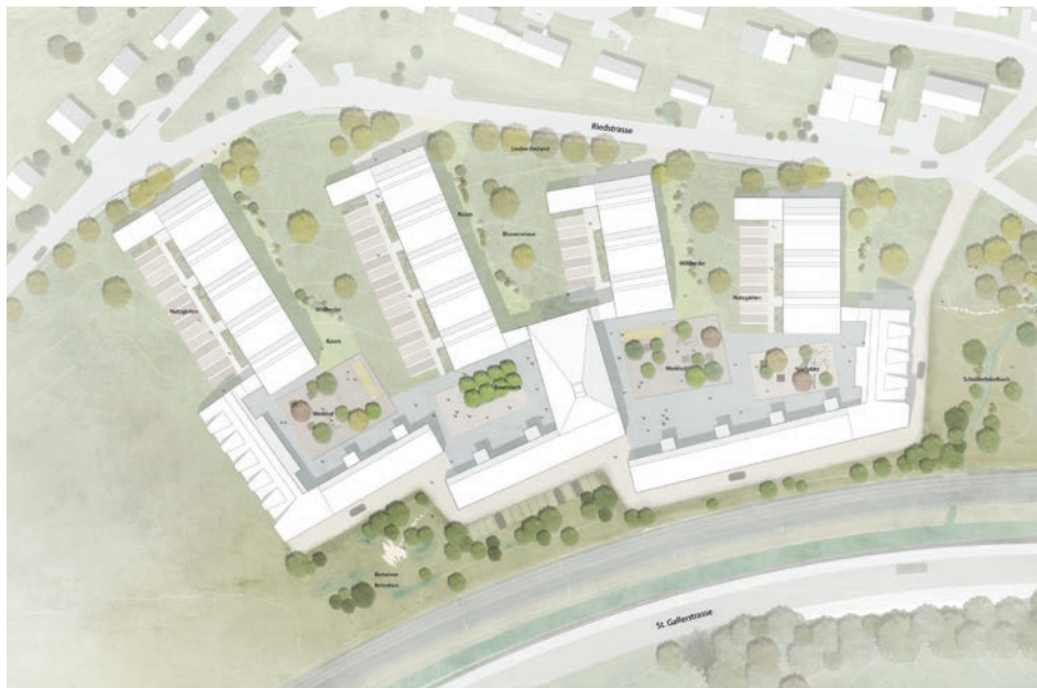
Aus der Vogelschau gut erkennbar sind die Lärmschutz-Riegel mit der gedeckten Parkierung zur Hauptstrasse hin und die Gehöft-Struktur der ganzen Anlage.
