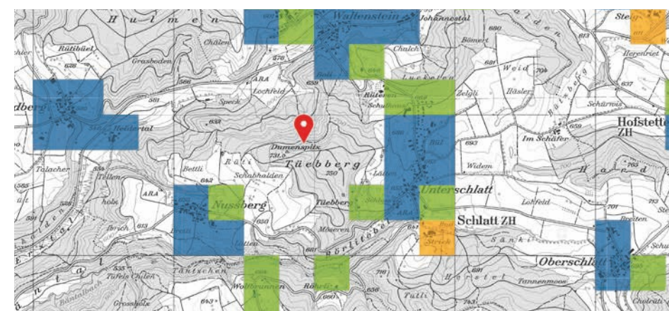
Der Breitbandatlas gibt eine Übersicht über die Versorgung der Schweiz mit modernen Telekommunikationsnetzen. Die Versorgungssituation wird in Form von statistischen Daten pro Planquadrat (250x250 Meter) dargestellt. Die Karte zeigt, in wie vielen Gebäuden eine Internet-Download-Geschwindigkeit von 10 Mbit/s oder mehr über Festnetz angeboten wird.
