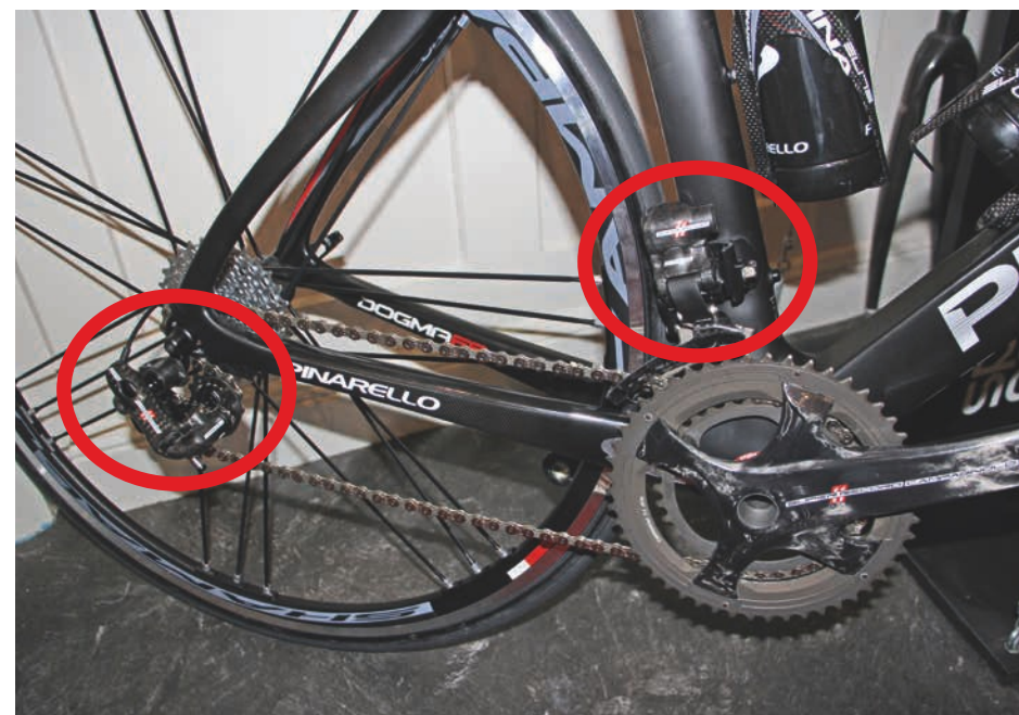
Technische Neuerungen: das «Automatikgetriebe» (oben) und die elektronische Schaltung (unten)
