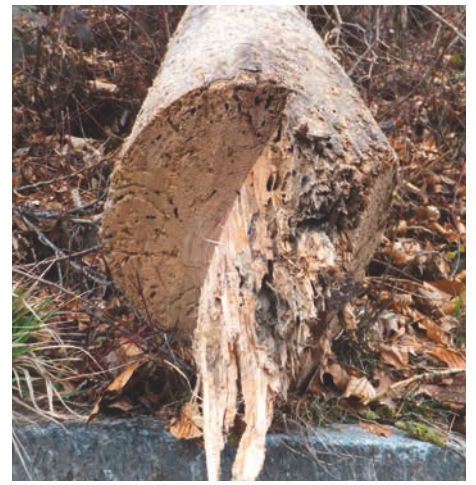
Äusserlich machte diese Föhre mit 50cm Durchmesser einen stabilen Eindruck. Der Querschnitt zeigt aber, dass die holzabbauenden Insekten nur noch wenige Quadratzentimeter im Kern ausgelassen haben.
