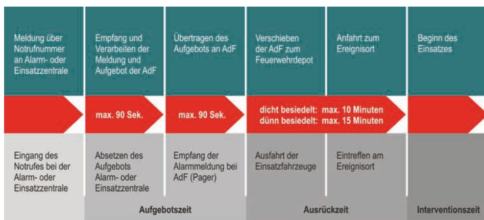
Ablauf Alarmeingang Einsatzleitzentrale bis Intervention durch die Feuerwehr
