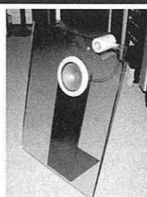
Dipollautsprecher mit Schallwand aus Glas
