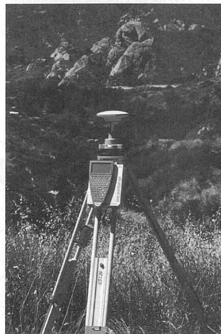
GPS-Empfänger für Vermessungsaufgaben (Leica GPS System 500)
