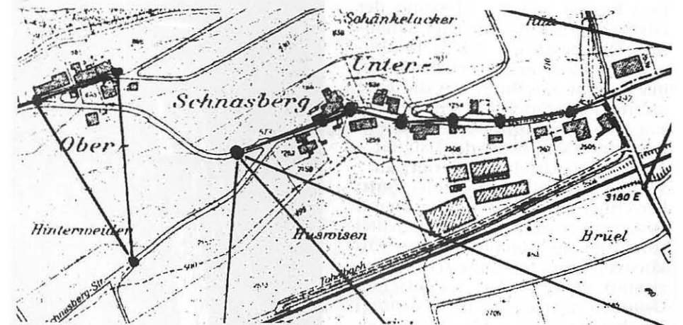
Ausschnitt aus dem Netzplan: Lagefixpunkte im Schnasberg
