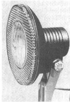
Halogenscheinwerfer (Lumotec) mit integriertem Reflektor.
