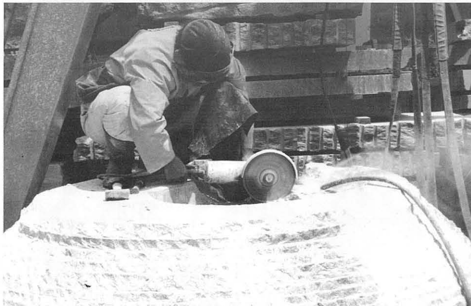
Rohbearbeitung mit der Fräse
