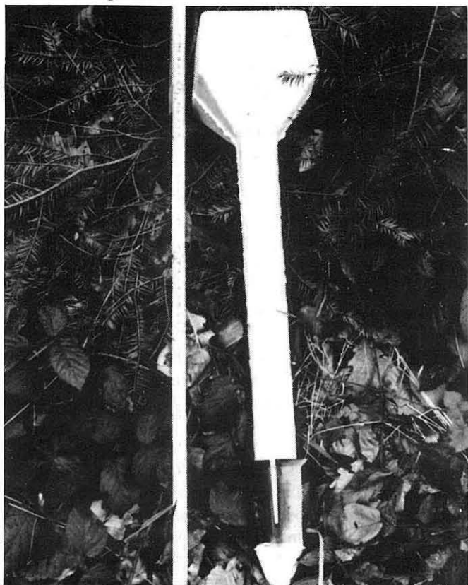
Einer der 747 eingesetzten Kunststoffmarksteine. Leichter zu transportieren, wie auch zu setzen. Bei der nötigen Sorgfalt der Waldbesitzer sicher auch so dauerhaft wie Granit.
