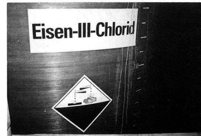
Menge Eisen-III-Chlorid beigefügt. Das Eisen bildet mit dem Phosphat unlösliches Eisenphosphat und fällt aus. Anstelle der Phosphate sind nun aber Chloride im Wasser. Sie erhöhen die Salzkonzentration der Gewässer – eine eher unerwünschte Nebenwirkung dieses Vorganges. Das Eisen, das dazugegeben wird und mit dem Klärschlamm ausgebracht wird, schadet offensichtlich dem Boden nicht. Die Erdkruste besteht ja zu einem grossen Teil aus Eisensilikaten.
