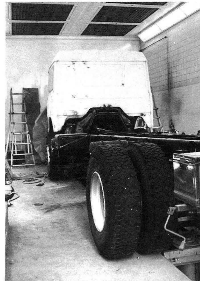
Spritz- und Einbrennkabine für Lastwagen
